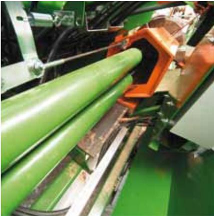
Kräftig und schnell. Das Doppelzylindersystem sorgt für einen doppelt so schnellen Rücklauf und somit höhere Stundenleistung.
