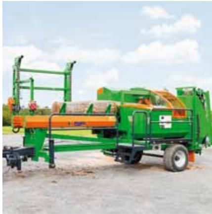
Der Spaltfix K-540 lässt sich optional mit dem Traktorfahrwerk bequem transportieren.
