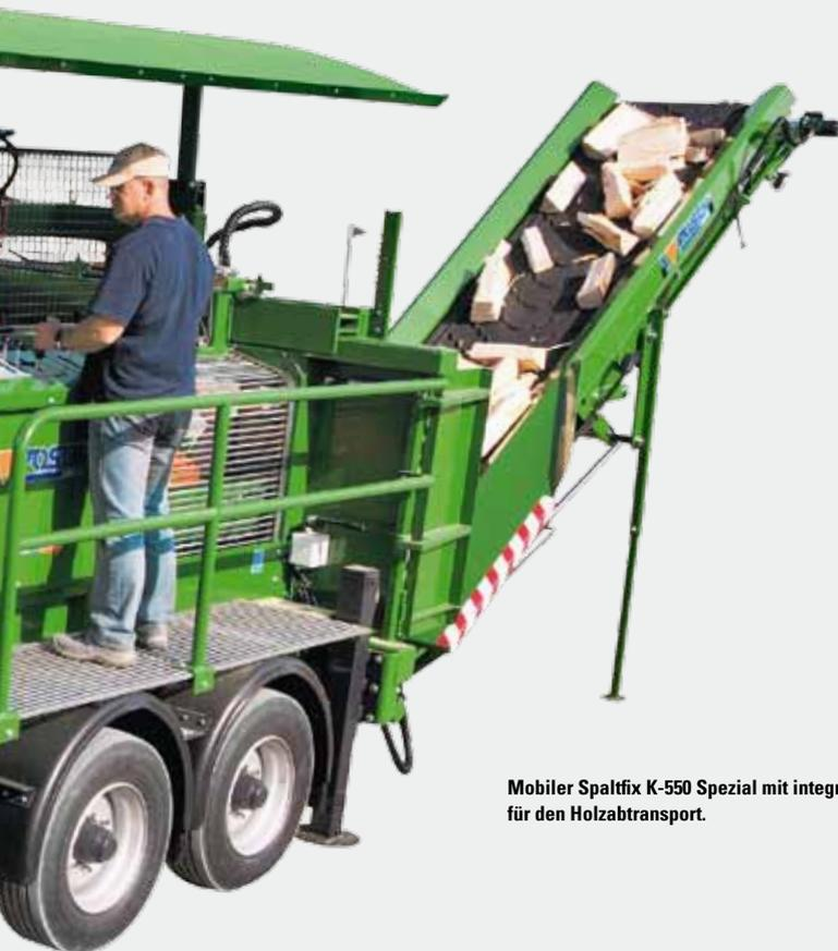
**Mobiler Spaltfix K-550 Spezial mit integrierter Holzbeschickung, Knickförderband für den Holzabtransport.**
