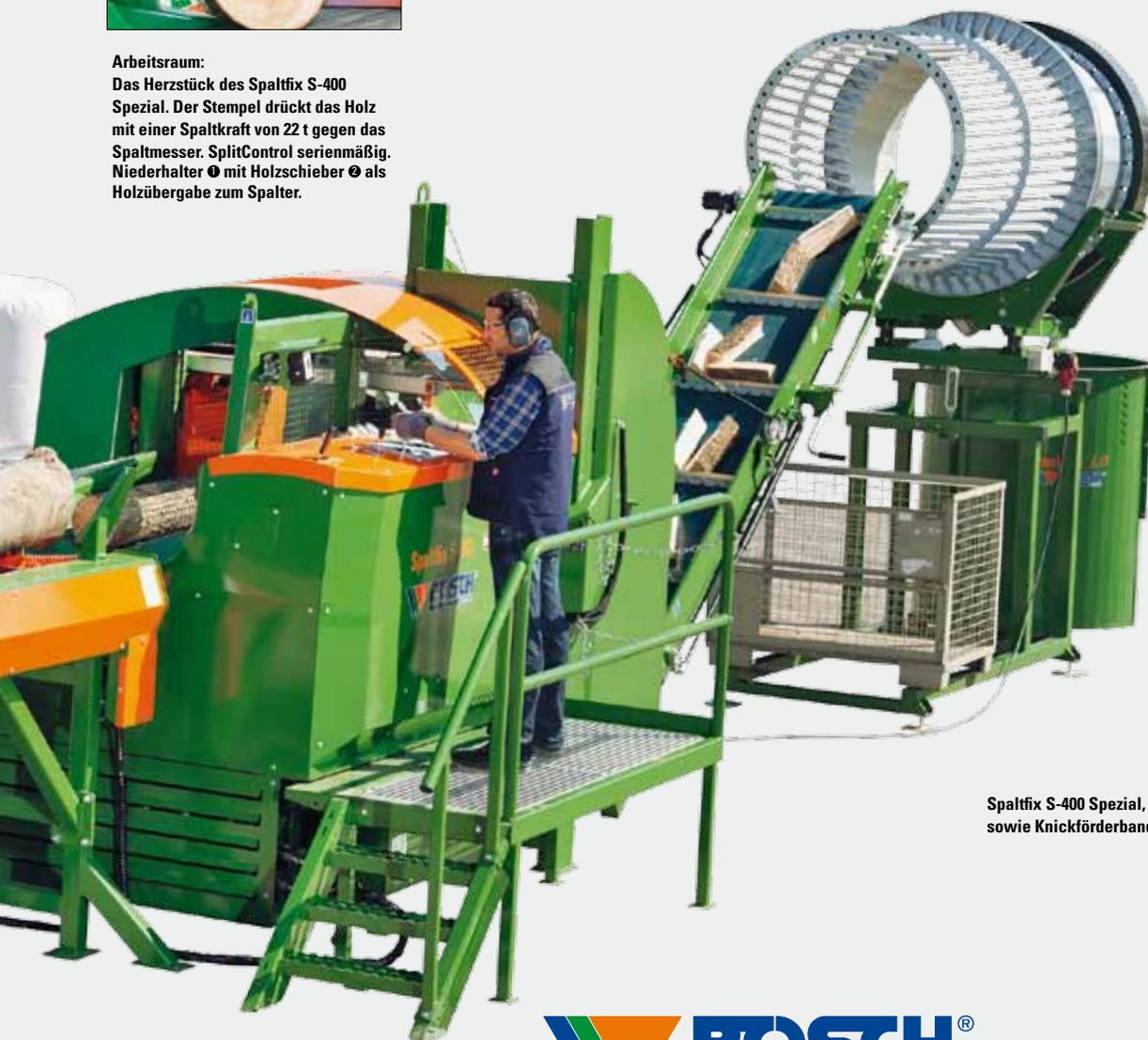
Spaltfix S-400 Spezial, Walzenförderer und Querförderer sowie Knickförderband für den Holzabtransport.
