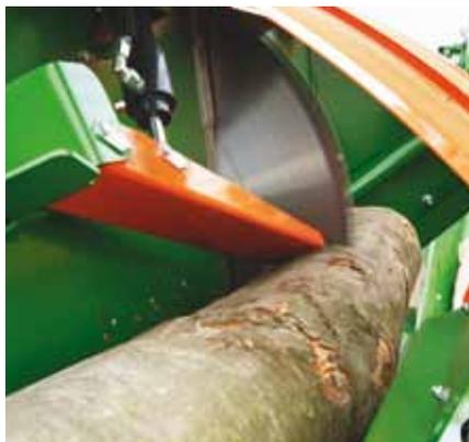
Der automatische, hydraulische Holzniederhalter.
