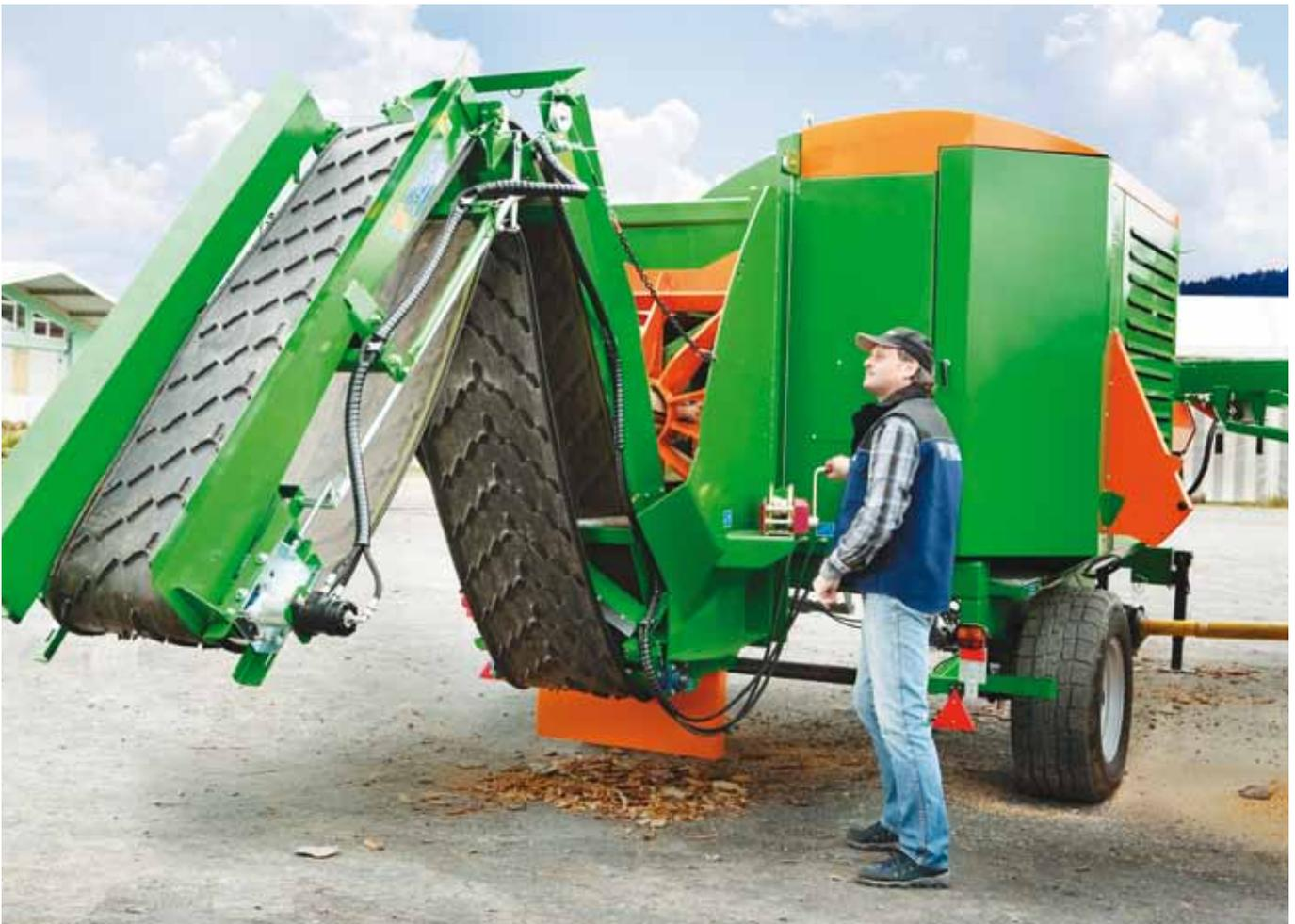
Das optionale Knickförderband gibt es in 4 m bzw. 6 m Länge. In Transportstellung wird es einfach (manuell oder hydraulisch) und platzsparend zur Maschine geklappt.
