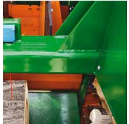
SplitControl für die automatische Holzmenge- und Spaltmesserstellung. Gleichmäßigere Holz-scheite sind das Ergebnis.
