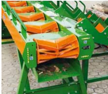
Robuster Walzenförderer zur kontinuierlichen Beschickung des Spaltfix.
