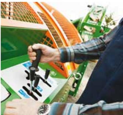
Einhand-Joystick-Steuerung für einfach Bedienung.
