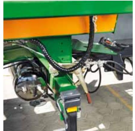
Traktorfahrwerk mit Druckluftbremse.
