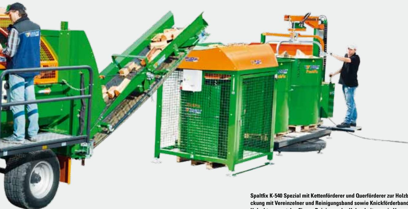
Spaltfix K-540 Spezial mit Kettenförderer und Querförderer zur Holzbeschickung mit Vereinzler und Reinigungsband sowie Knickförderband für den Holzabtransport. LogFix zur Reinigung der Holzscheite sowie Verpackungslösung PackFix mit hydraulischem Schwenktisch.
