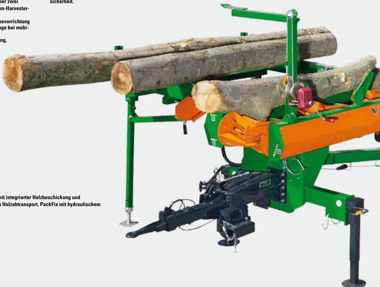
Mobiler Spaltfix K-440 mit integrierter Holzbeschickung und Knickförderband für den Holzabtransport, PackFix mit hydraulischem Schwenktisch.
