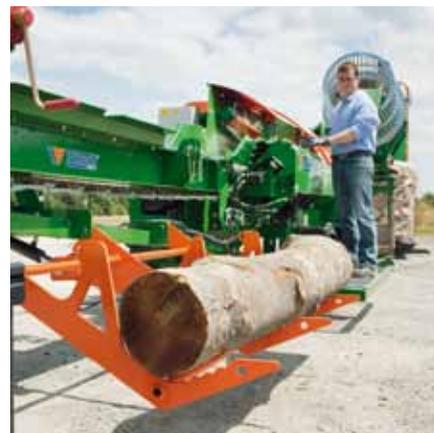
Der S-350 mit integrierter Beschickung und optionaler Stammhebevorrichtung.
